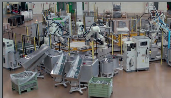
SYNDY – Modular robotized cells for wiring and assembling / Celle robotizzate modulari per cablaggio e montaggio
