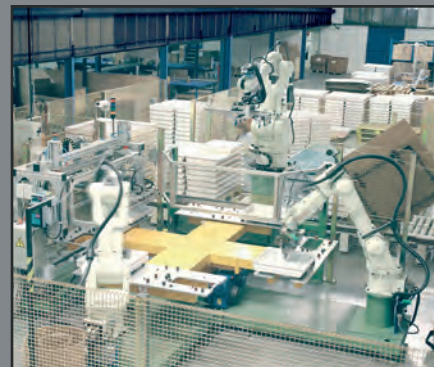
SYNDY – Modular robotized cells for wiring and assembling / Celle robotizzate modulari per cablaggio e montaggio
